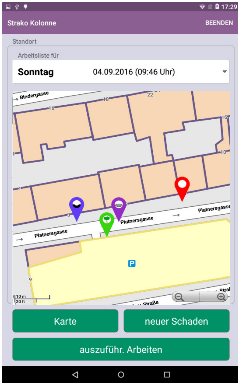
Der Standort wird mit rotem Symbol angezeigt, die Schäden mit unterschiedlichen, je nach Schadensart.
